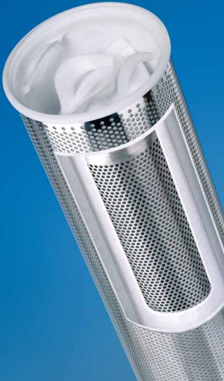
As alças do anel SENTINEL e no centro da luva permitem a extração fácil do elemento.
